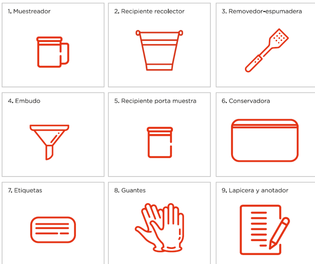
Figura 5.3 Representación de los materiales necesarios para realizar un muestreo de laguna de efluentes. *El muestreador se puede confeccionar mediante un palo de madera o un caño de PVC de 1 pulgada, con un largo mínimo de la mitad del ancho de laguna. En uno de los extremos sujetar bien firme un recipiente plástico o un cucharón de sopa grande de acero inoxidable.
